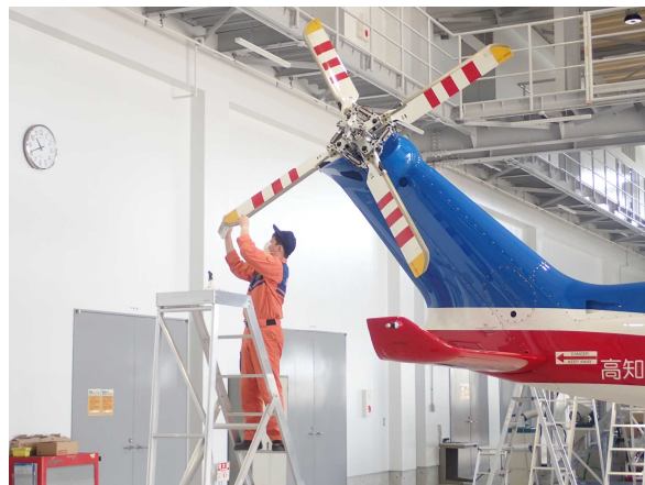
テールローター確認作業
