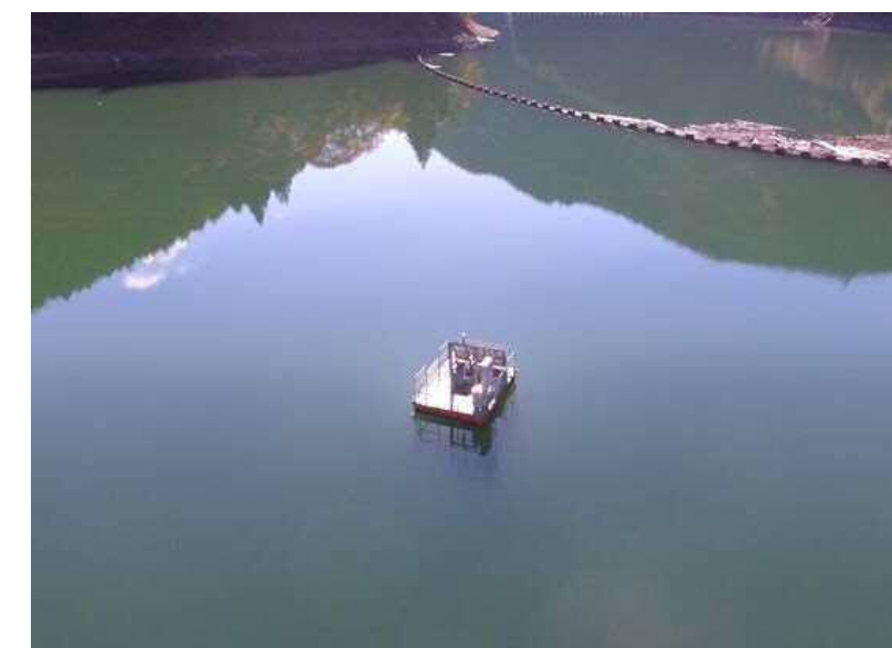
▲自動濁度計 全景
