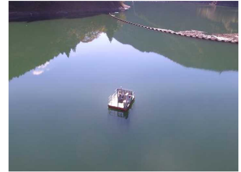
▲自動濁度計 全景
