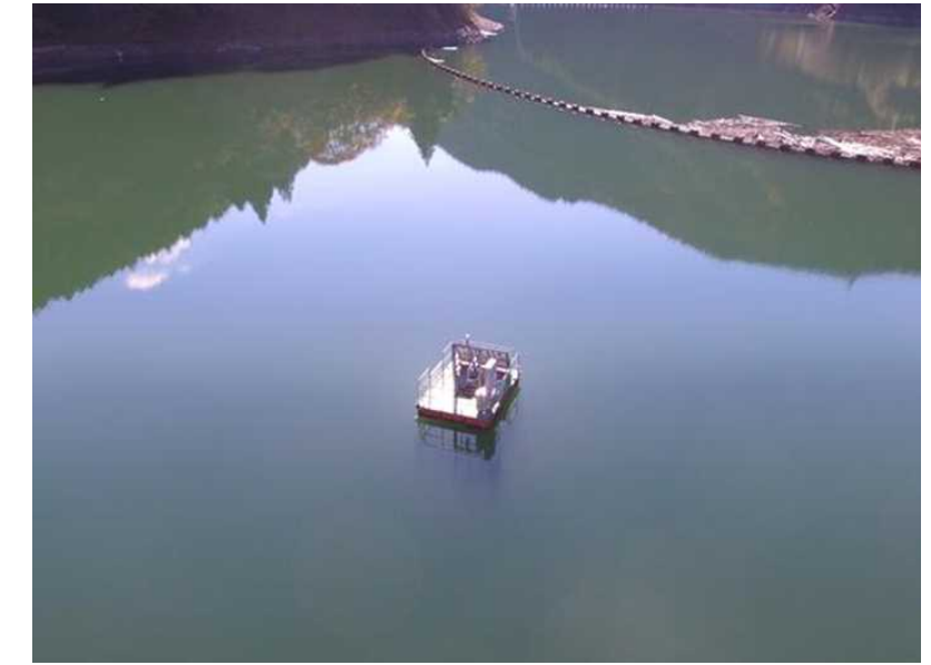
▲自動濁度計 全景
