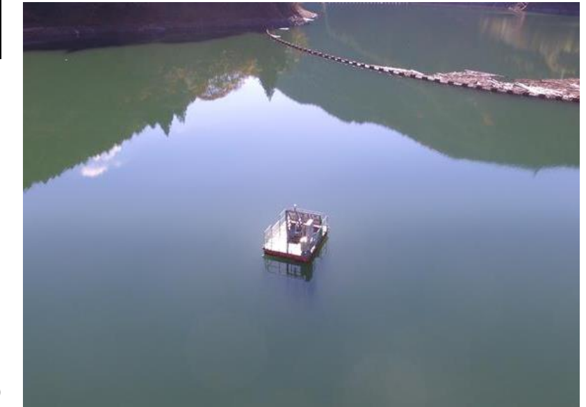
▲自動濁度計 全景
