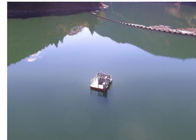
▲自動濁度計 全景
