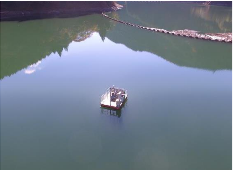
▲自動濁度計 全景
