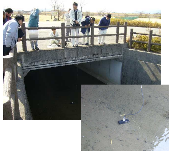
濁度計を使った濁りの調査の様子
