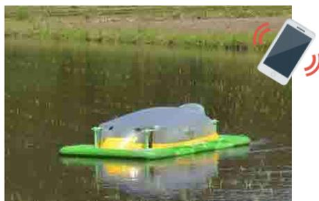
水管理システムによる水田の水位等の遠隔管理
