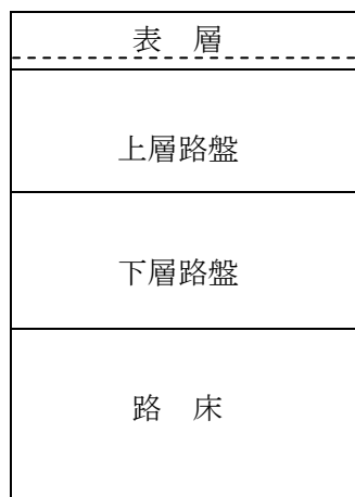
図1 アスファルト舗装の構造
