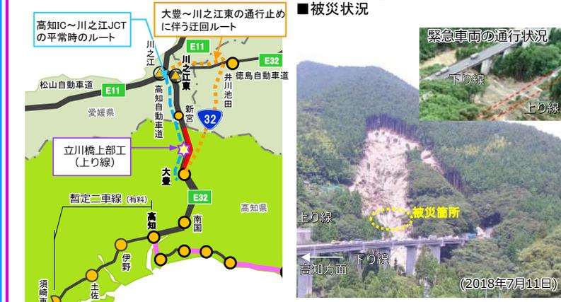
2018年7月7日未明\_道路区域外の法面崩壊により橋梁上部工が流失
