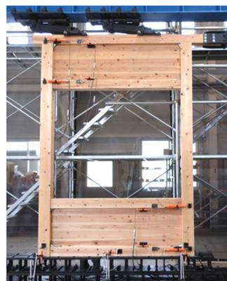
図1 ラーメン構造による耐力壁
