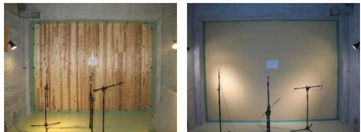
図 1 試験体設置状況（左：音源室側、右：受信室側）
