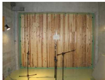
図 1 試験体設置状況（左：音源室側、右：受音室側）
