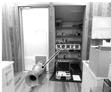
図 2 気密性能測定状況
