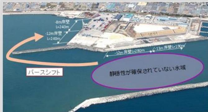
図 1-45 切断されたロープとバースシフトの状況
