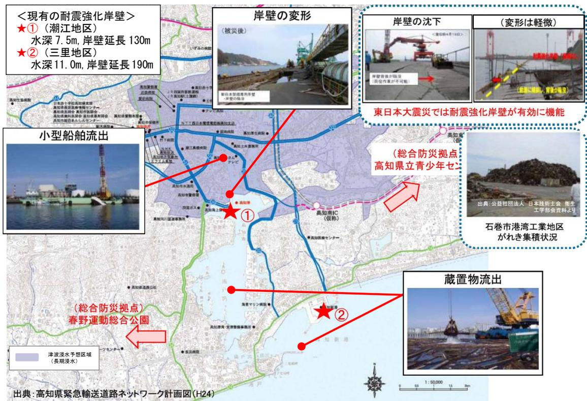
図 1-64 耐震強化岸壁の状況
