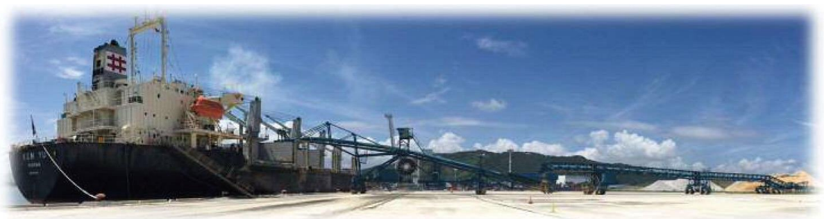
図 1-27 石灰石の荷役状況
