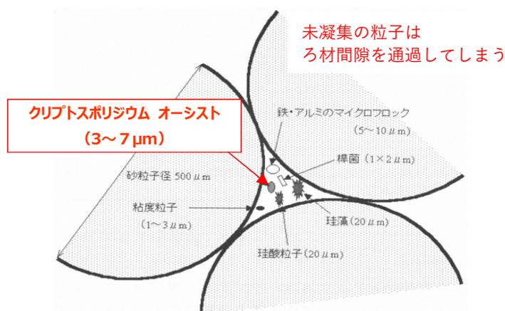
図 4-4-4 ろ材間隙の模式図
