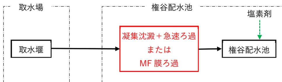
図 4-3-11 ろ過設備導入後の浄水処理フロー
