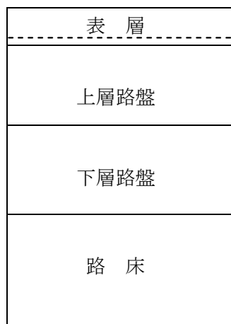
図1 アスファルト舗装の構造
