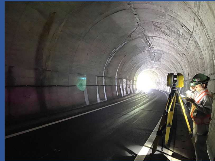
地上型3Dレーザースキャナーによる 測量状況
