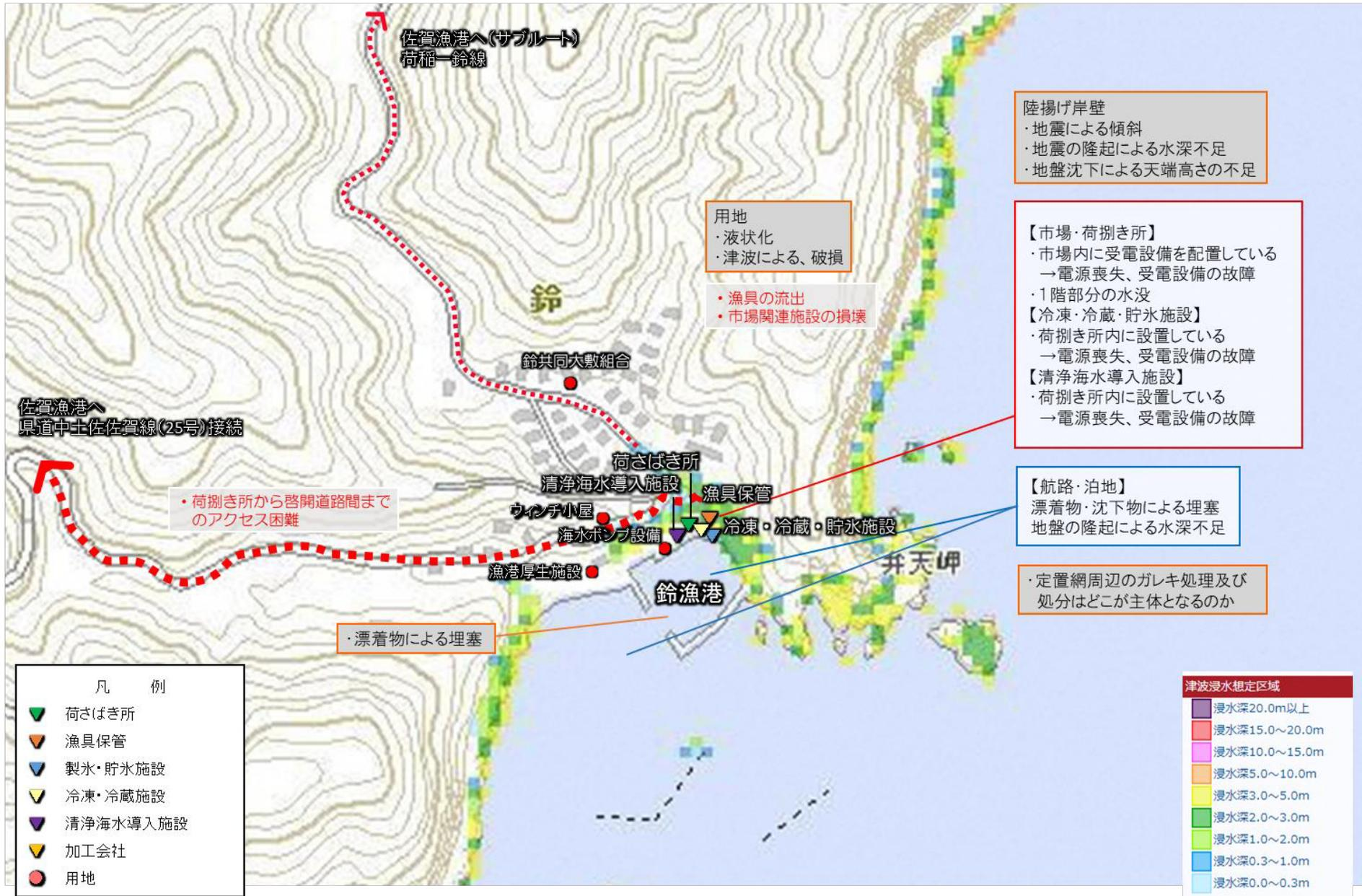
図-2.8 鈴漁港周辺のL1地震津波における浸水深と被害想定
