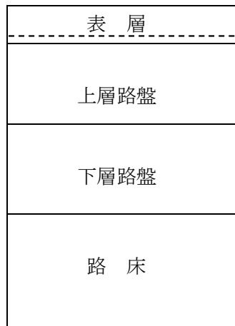
図1 アスファルト舗装の構造
