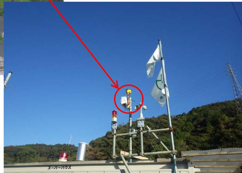
既知点と移動局にGNSSアンテナを設置し、リアルタイムに移動局の座標を計算する。
