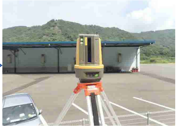
杭ナビ設置完了
