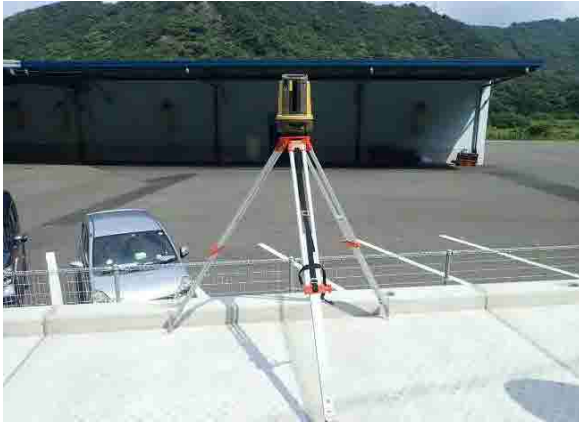
杭ナビの設置
