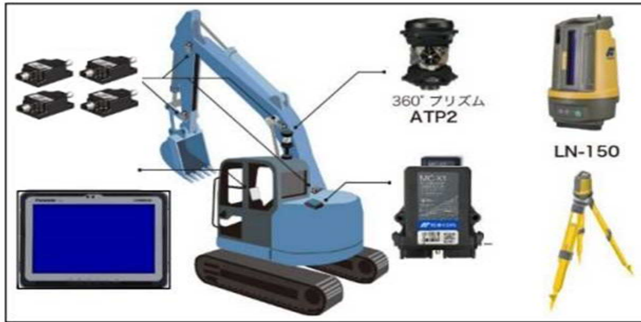
図：杭ナビショベル標準仕様システム構成
