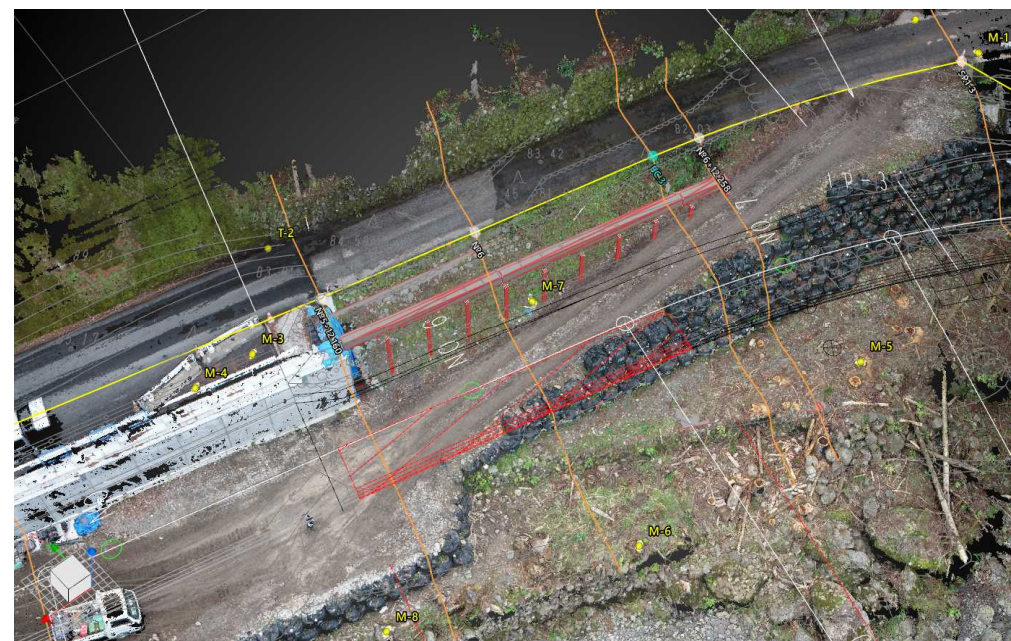
3次元起工測量データ+3次元設計データ
