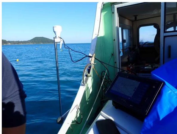
図3 アンカー設置位置探索用のGPS
