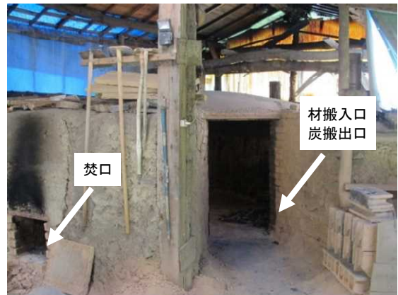
図1 黒炭窯（高知県1号系） （左下：焚口、右：材及び炭の搬入・搬出）
