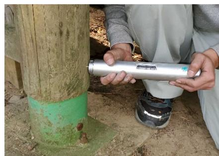
図2 腐朽劣化状況調査(ピロディン)
