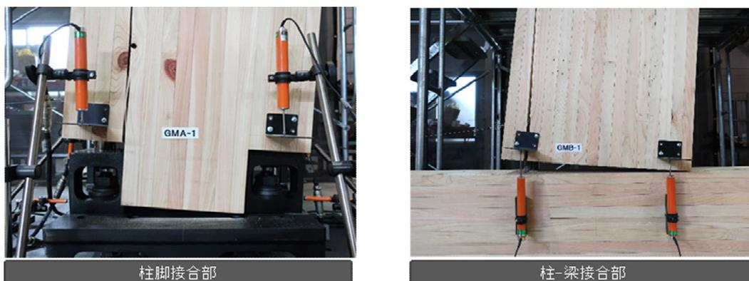
図3 各試験体の試験状況（終局）
