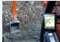
ICT建設機械
