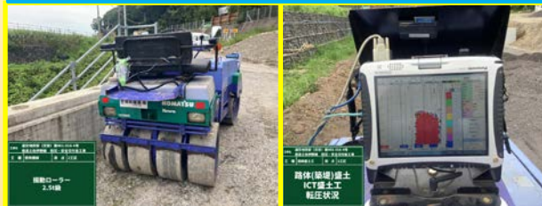
転圧システム搭載振動ローラー【2.5 t 級】
