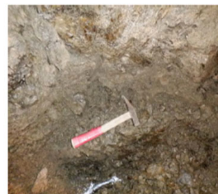
写真3 支持層上面高さに確認されるCm級泥岩層(EL=111.70m)
