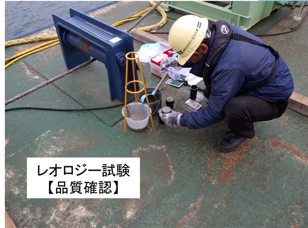
水中部注入時での水分量の増加、冬季作業時の低温による流動性の低下等を想定し、現場条件を再現して試験練りを行い、所定の品質を確保できるように配合の調整を行った。
