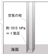
図 気圧を空気の柱で表す
