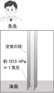
図 気圧を空気の柱で表す
