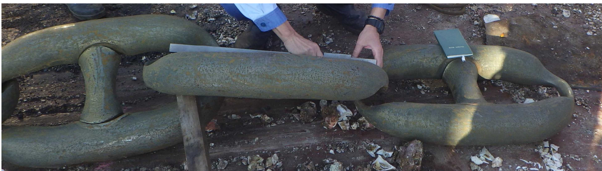
図 4-2 回収した下部補強鎖中部の末端
