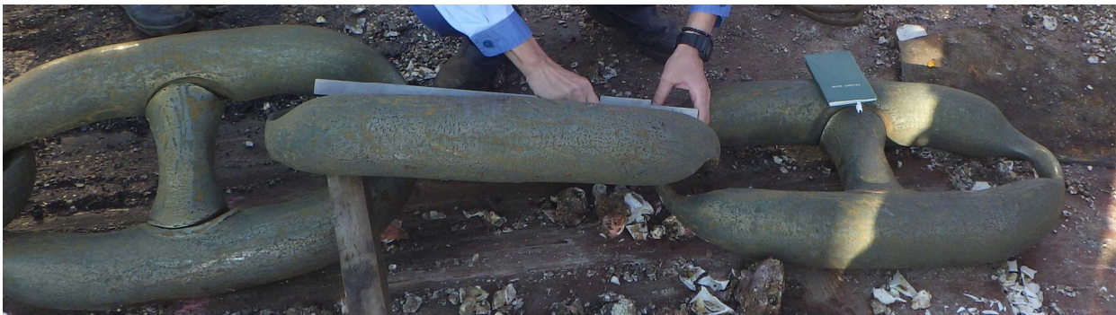
図 4-2 回収した下部補強鎖中部の末端（写真左が浮体側、右がアンカー側、写真一番右が 21 リンク目）
