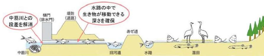
図 2-1-30 樋門の段差解消の整備イメージ
