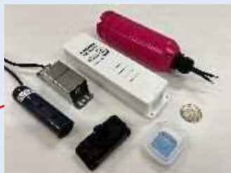
実証実験に用いている6種類の浸水センサ
