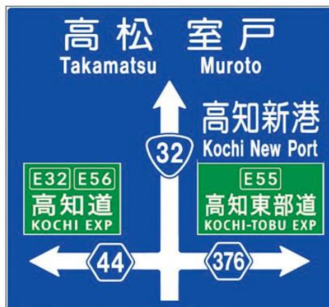
【高速道路ナンバリング標識の整備事例】
