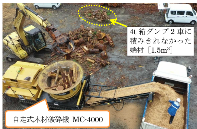
図3 端材主体（スギ）破砕処理状況
