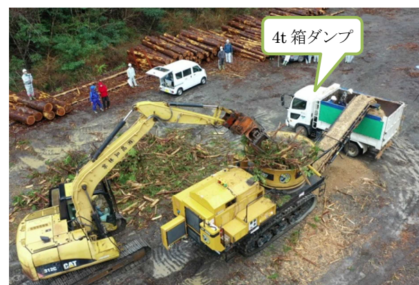
図4 枝条主体（ヒノキ）破砕処理状況
