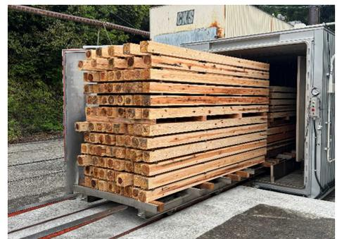
図3 乾燥経過予測モデル実証試験の様子
