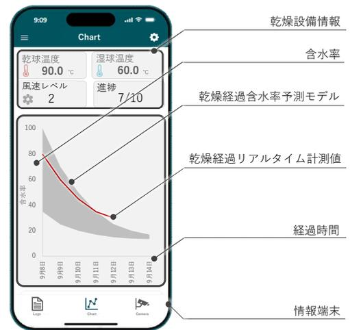
図1 乾燥経過モニタリングシステムのイメージ
