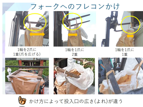
図 8 フォークへのフレコンのかけ方
