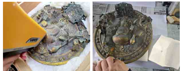
蛍光X線測定 クリーニング作業 (株式会社文化財保存活用研究所提供)
