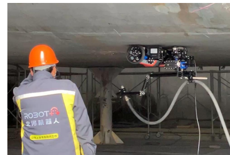
↑ブラストロボット (昨年、中国で開発。大手含めて国内で導入事例は現時点でない)
