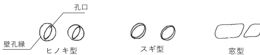
図4 針葉樹における分野壁孔の特徴
