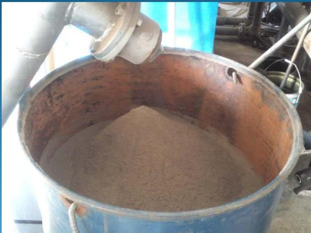
ペレット燃焼後の燃焼灰(灰送り装置からドラム缶へ)
