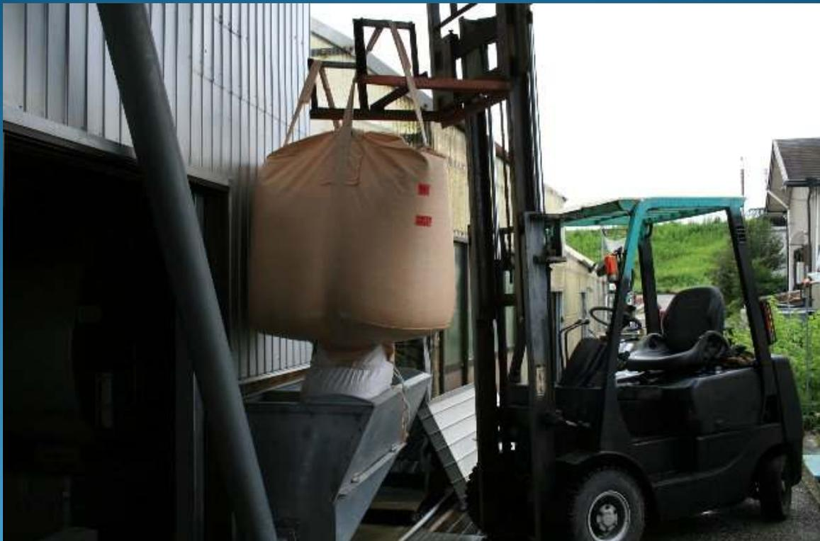
ペレット投入の様子(フレコンバッグ 約600kg)
