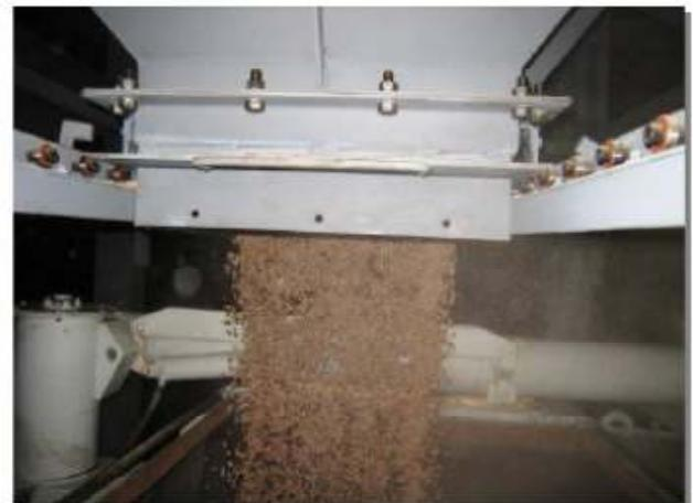
ペレットタンクの下部にバルク車を設置し、タンクの下部を開いてペレットを投入する。
