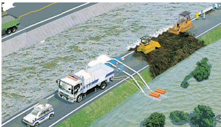
排水ポンプ車配置イメージ（四国地方整備局パンフレットより）
