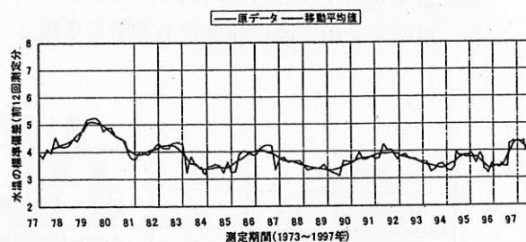
図16 高保木堰の水温標準偏差の時系列変化 (移動平均法：区間=6回測定分)
