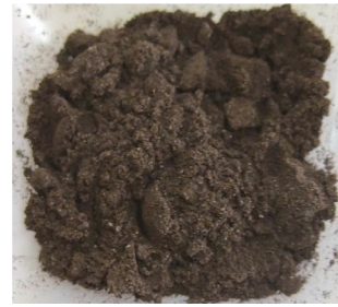
写真2 900℃、1時間加熱後のホワイトペレット灰
