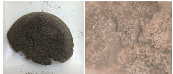
写真3 900℃、1時間加熱処理後のブラウンペレット灰 (右×20)
