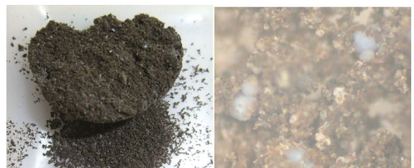
写真4 900℃、1時間加熱処理後のブラウンペレット灰 (右×63)
